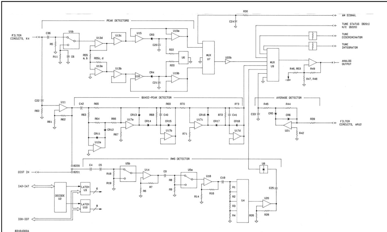
**FIGURE 4-9. Detector Circuits Block Diagram.**
