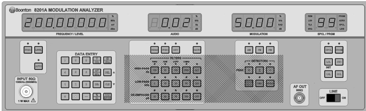
**FIGURE 3-6. Measurement Control Keys**
