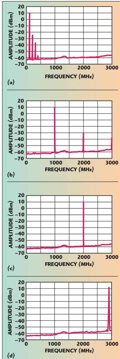
▲ Fig. 3 Spectral data at 100 MHz (a), 1 GHz (b), 2 GHz (c) and 2.9 GHz (d) ( $P_{out} = +10$  dBm).
